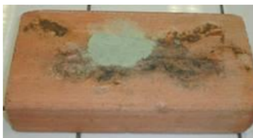
Sur une brique, on place le mélange
